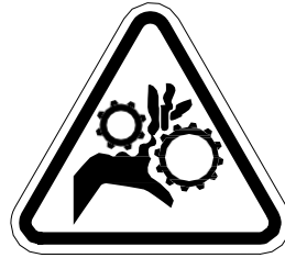
Рис. 4.2 Небезпека поранення, заподіяного обертливими частинами
