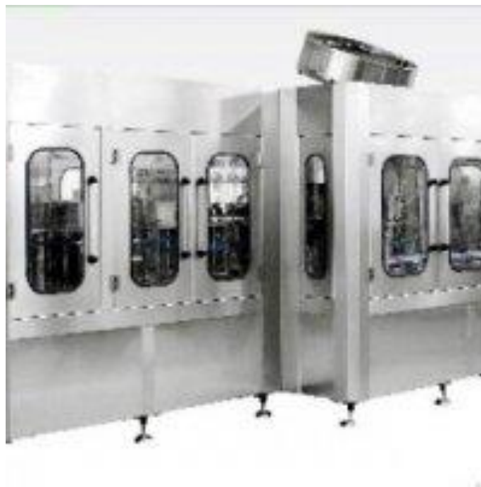
Рис. 1.11. Моноблок розливу соку з мякоттю. Моноблок серії RCGF це обладнання для розливу гарячих напоїв і зокрема соку з мякоттю. Даний моноблок включає в себе такі вузли: блок ополіскування, блок наповнення мякоттю, блок наповнення соком та блок закупорювання (4 в 1). Передбачена можливість переналадки обладнання під різні типорозміри пляшки. Програмний контролер від відомого бренду SIEMENS.
