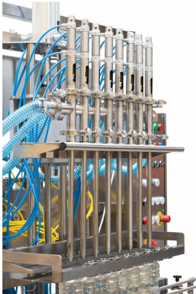
Рис. 1.1.2. Моноблок розливу соку з мякоттю. Автоматична лінія для розливу тари різного об'єму від 0,5 до 5 літрів. Комплектація та продуктивність лінії обумовлюється з кожним клієнтом окремо. Все
