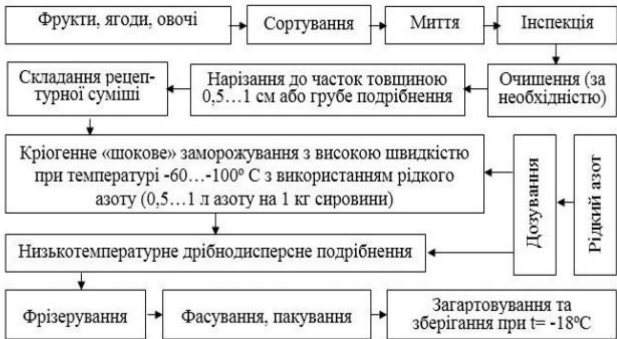
Рис. 3.8. Принципова технологічна схема виробництва – плодоовочевого морозива (сорбетів), отриманого з використанням кріогенного «шокового» заморожування та низькотемпературного дрібнодисперсного подрібнення
