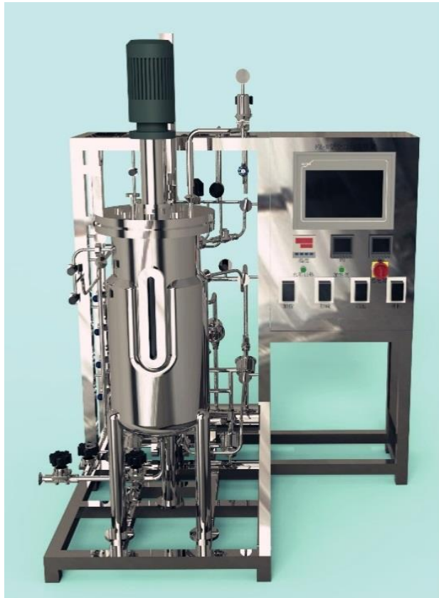
Рис. 5.1. Візуальний вигляд ферментеру об'ємом 200 л для виробничого культивування клітин Lactobacillus delbrueckii ssp. bulgaricus
