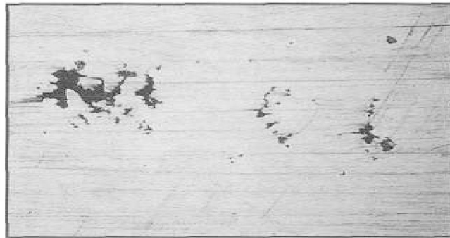
Рис. 8. Поверхнева пористість, викликана домішками оксиду цинку
