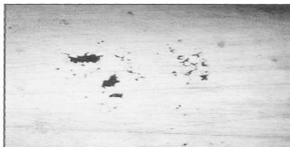
Рис. 2. Мікроріз деталі виробу з газовою пористістю, викликаною домішками (100-кратне збільшення)
