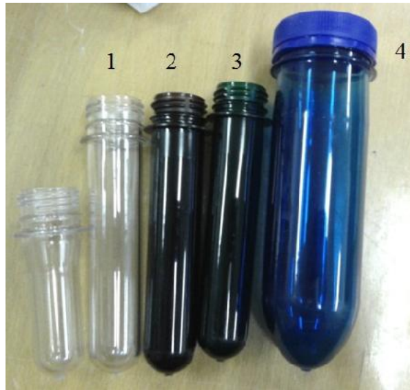
Рис.2.29. Зразки преформ: 1-прозора; 2-коричнева; 3-зелена, 4-синя(для наступного видування пляшок об'ємом 5л).
