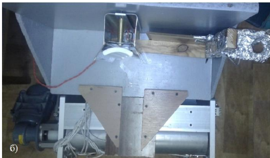
Рис.2.7. Установка для проведення експериментів: а)варіант для нагрівання плоских зразків; б)варіант для нагрівання преформ, вид зверху.
