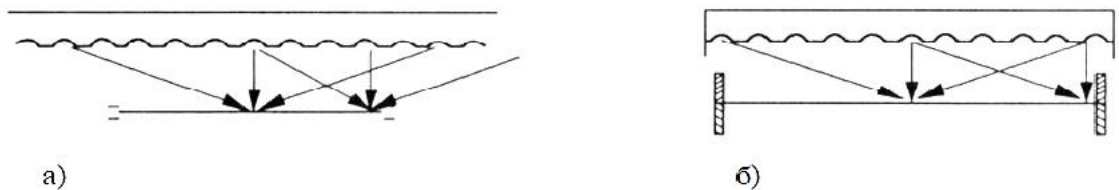
Рис.1.19. Використання нагрівачів в крайніх зонах: а) як ідеальний випадок;б) реальні умови при нагріванні матеріалу із затискної рамою.
