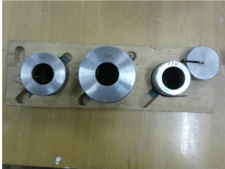
Рис.2.10. Елементи, масою 0,2; 0,5; 1 та 2 кг, що використовувались для прикладання навантаження.
