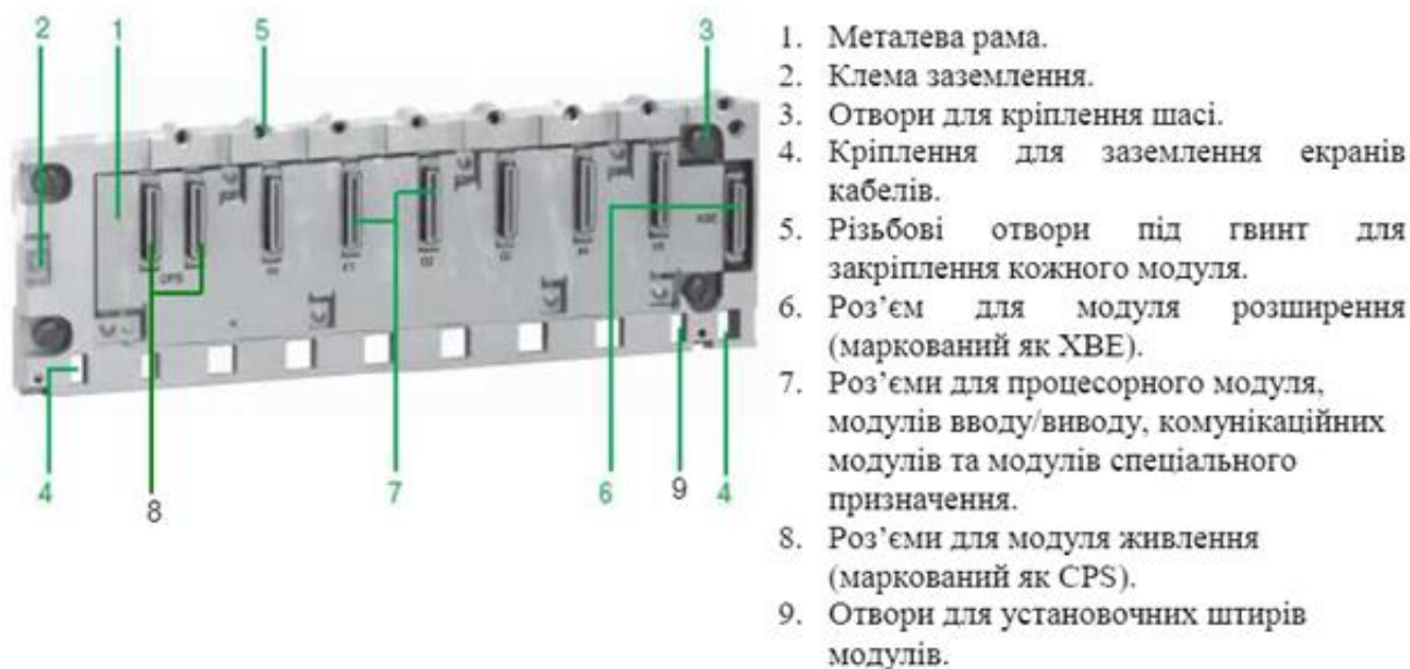
Рис.3.2 Шасі Modicon M340
