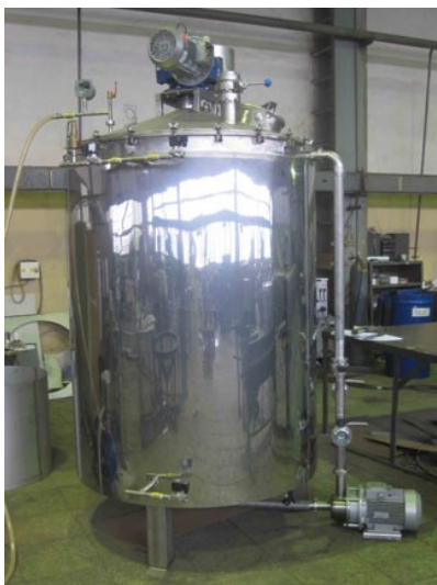
Рис 4.3. Ротаційний вакуум-випарний апарат, місткістю 1000 л Виробник: ТОВ «Агромаш», Україна [41]
