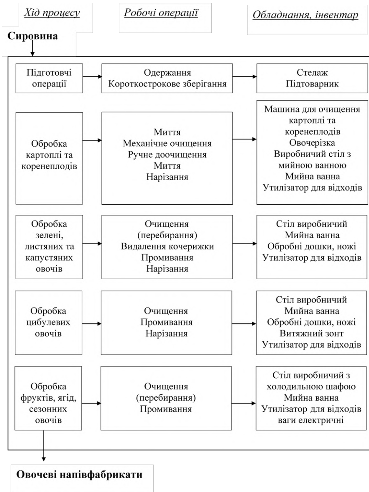
Рис. 2.3 – Структурно-технологічна схема виробничого процесу овочевого цеху проектного закладу
