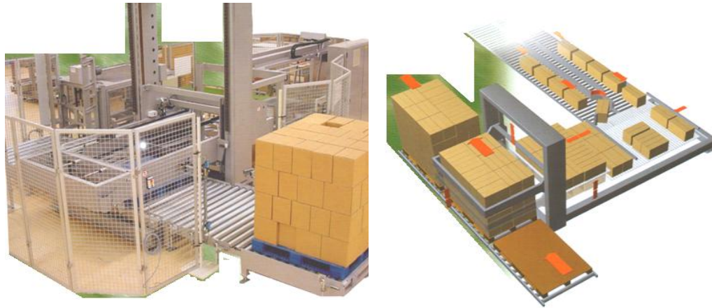
Рис. Технологічна схема та загальний вид пакетоформуючої машини «P4Sidel» концерн «Сermex» (Франція) Робот для викладання продукції на піддон
