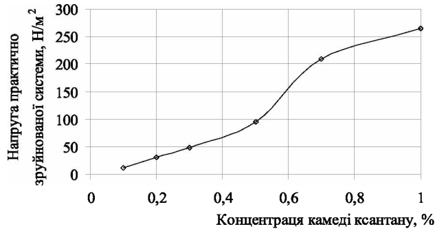
Рис. 4. Залежність напруги практично зруйнованої системи ( P_m ) від концентрації розчину камеді ксантану
