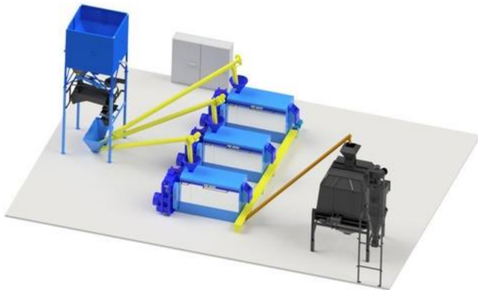
Рисунок 2.3. Технологічна схема одноразового пресування холодним способом
