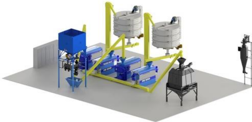
Рисунок 2.5. Технологічна схема холодно-гарячого пресування
