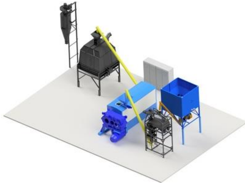
Рисунок 2.6. Технологічна схема попереднього холодного пресування
