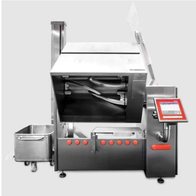
Рис. 3 – Фаршмішалка фірми LASKA, модель ME500 N [15]
