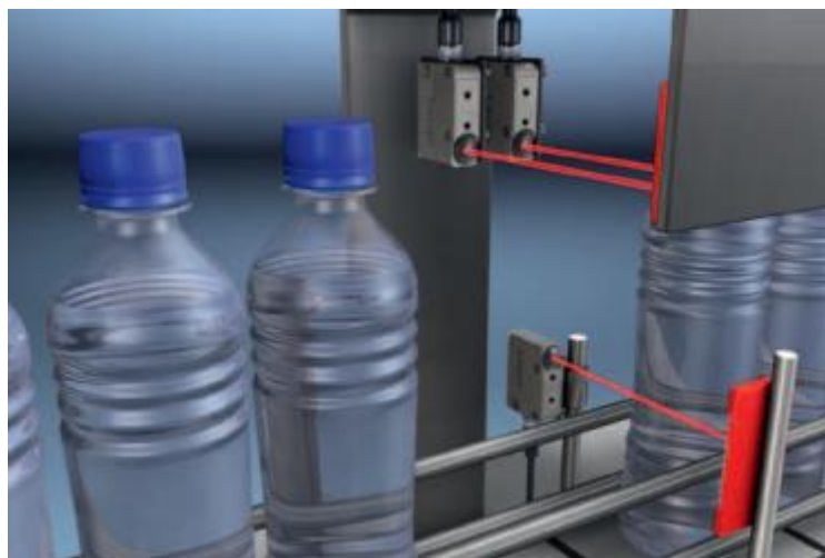
Рис 2.6 – Приклад встановлення датчика PRK18B.T2/4P-M12
