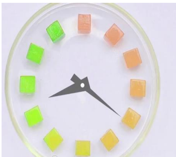
Рис. 1. Зміна кольору smart-тегу при різних стадіях свіжості
