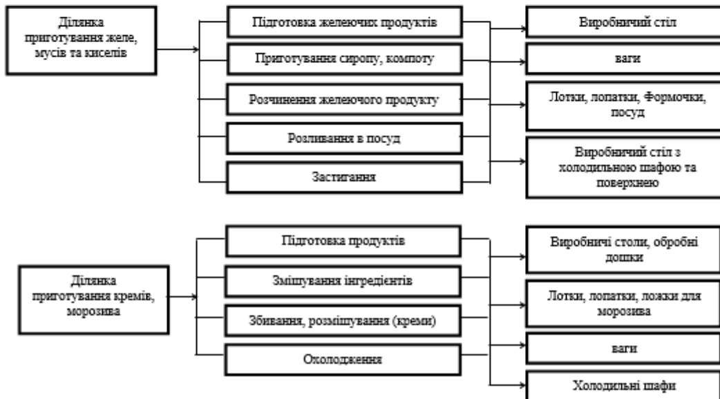
Рис. 2.5 - Структурно-технологічна схема виробничого процесу холодного цеху
