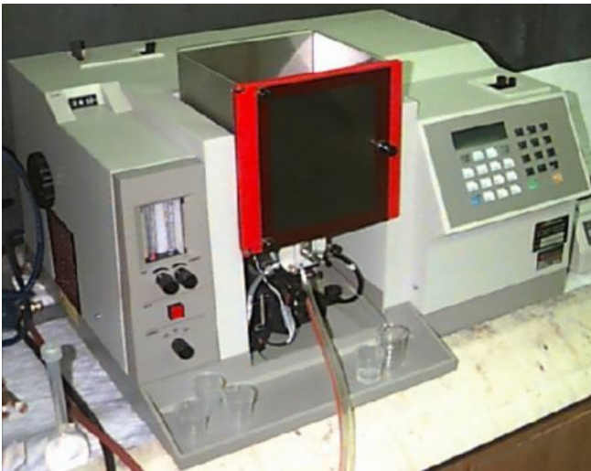
Рис. 1.15. Атомно-абсорбційний спектрометр з атомізацією у полум'ї
