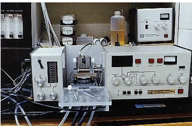
Рисунок 1.16. Атомно-абсорбційний спектрометр з атомізацією в графітовій печі
