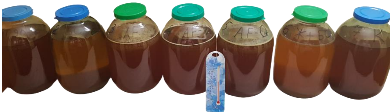
Рисунок 3.1 – Зразки на відстоюванні після внесення препаратів для освітлення та стабілізації згідно варіанту досліду: 1 – желатин; 2 – бентоніт; 3 – Плантис-АФ; 4 – Плантис АФ-П; 5 – Плантис АФ-Кью; 6 – желатин + бентоніт; 7 – контроль (самоосвітлення)
