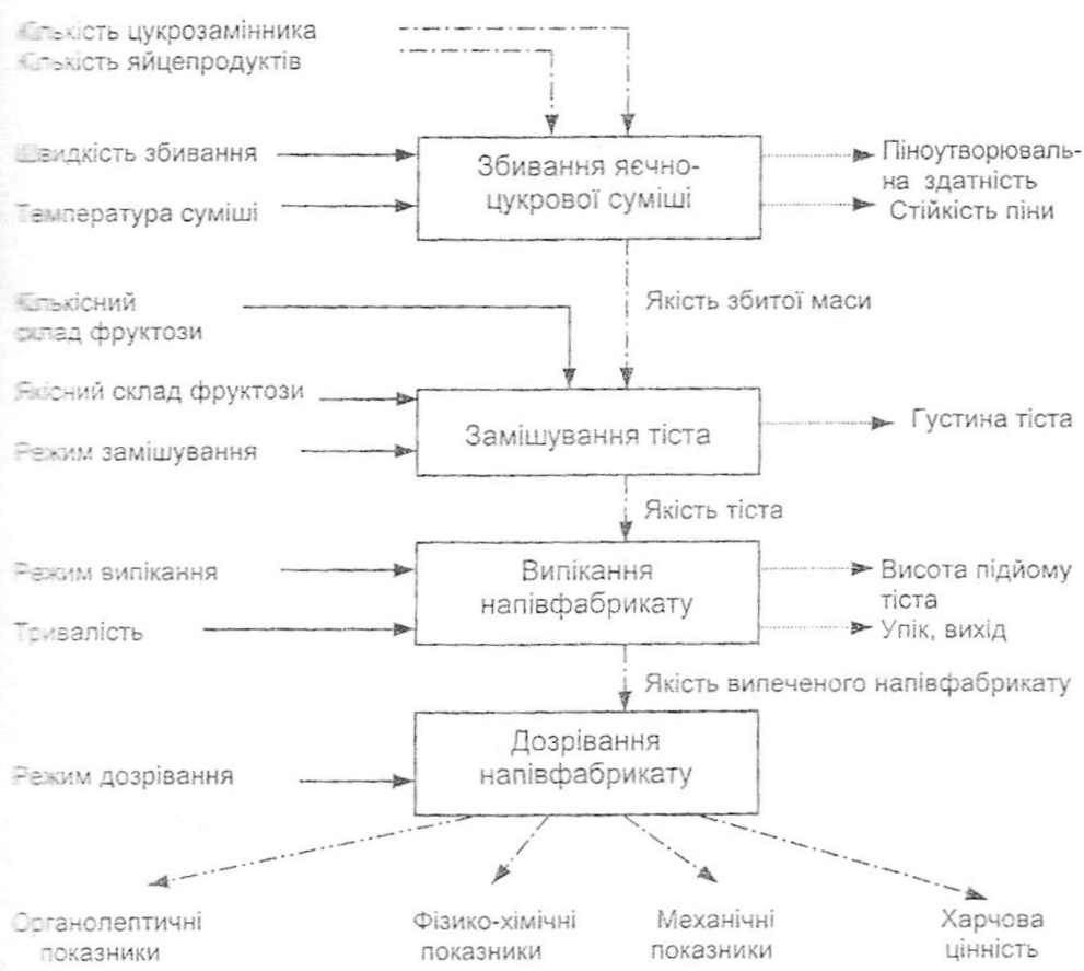
Рис. 1. Параметрична модель технологічної системи виробництва бісквітного напівфабрикату:
