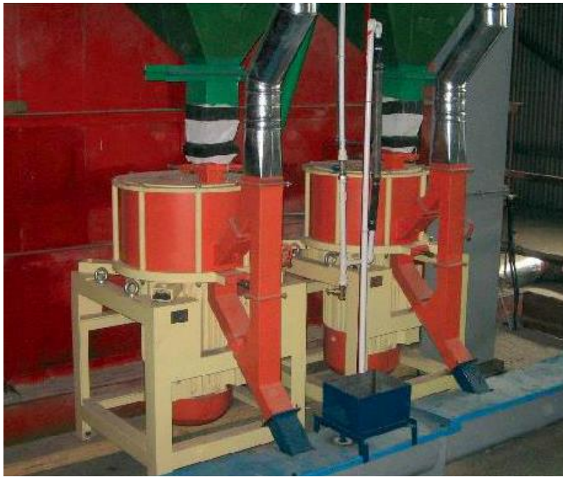
Рисунок 1.3 - Вузол дебраннінга, реалізований машинами «Каскад» на млині продуктивністю 60 т/добу.
