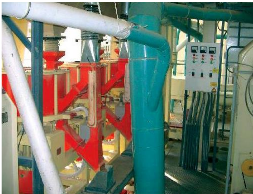
Рисунок 1.4 - Вузол дебраннінга, реалізований машинами «Каскад» на млині продуктивністю 100 т/добу.
