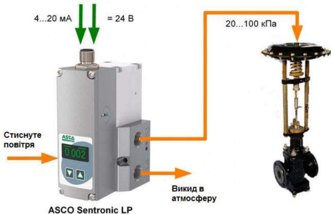
Рис. 2.11. Схема підключення ASCO NUMATICS Sentronic LP та клапану.
