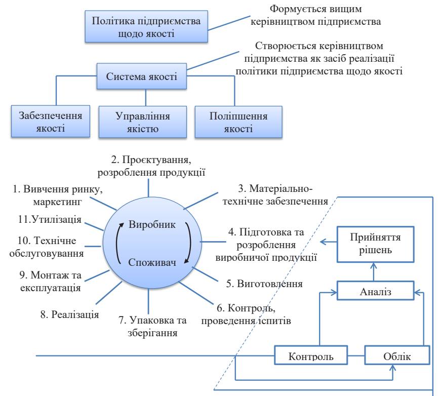
Рис. 1.3. Типові стадії життєвого циклу, на яких забезпечується якість продукції або «петля якості»
