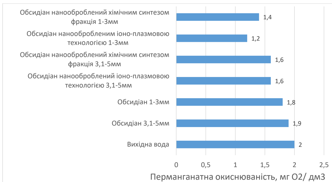
Рис. 3.2.1 – Вплив природного обсидіану та наномодифікованого різного фракційного складу та способу обробки на зміну перманганатної окиснюваності води
