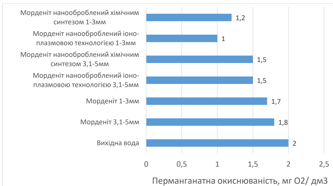
Рис. 3.1.1 – Вплив наномодифікації морденіту на перманганатну окиснюваність води до та після очищення
