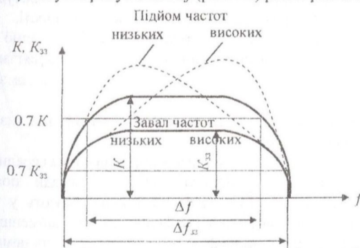
Рис. 7.4. Вплив лінійного негативного зворотного зв'язку на АЧХ підсилювача
