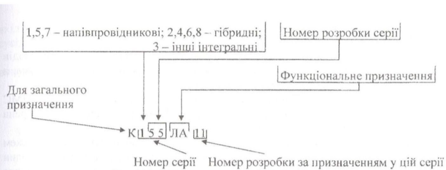
Рис. 15.3. Схема позначення цифрової мікросхеми
