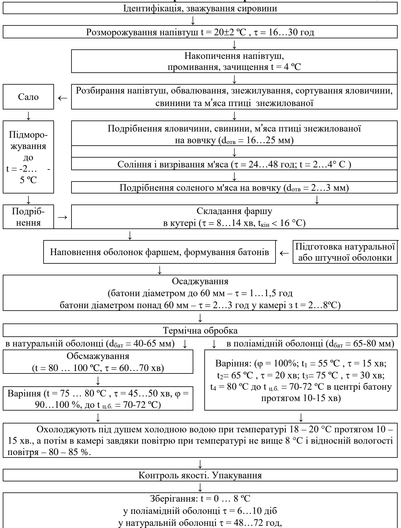
Рисунок 3.2 – Удосконалена технологічна схема виробництва варених ковбас з м'яса птиці
