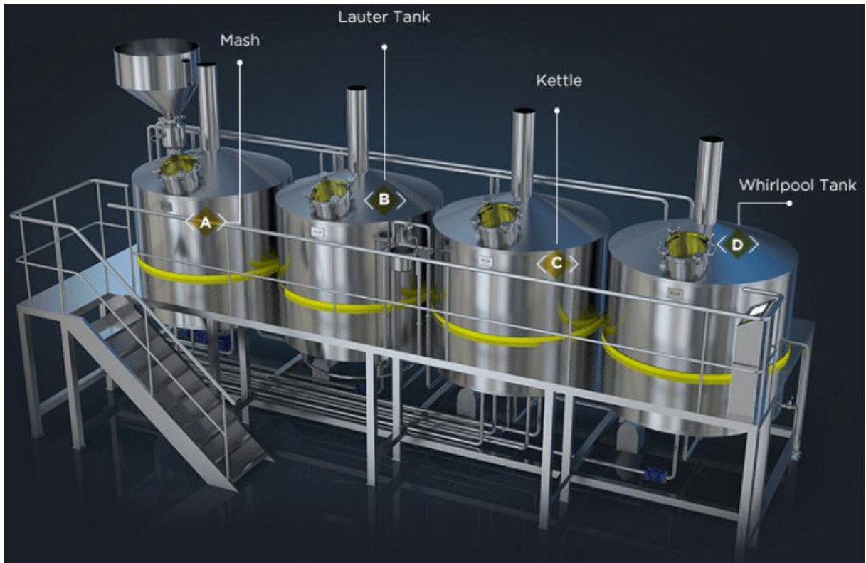
Рис. 1.9. Пивоварна система CARRY Brewtech 2000L
