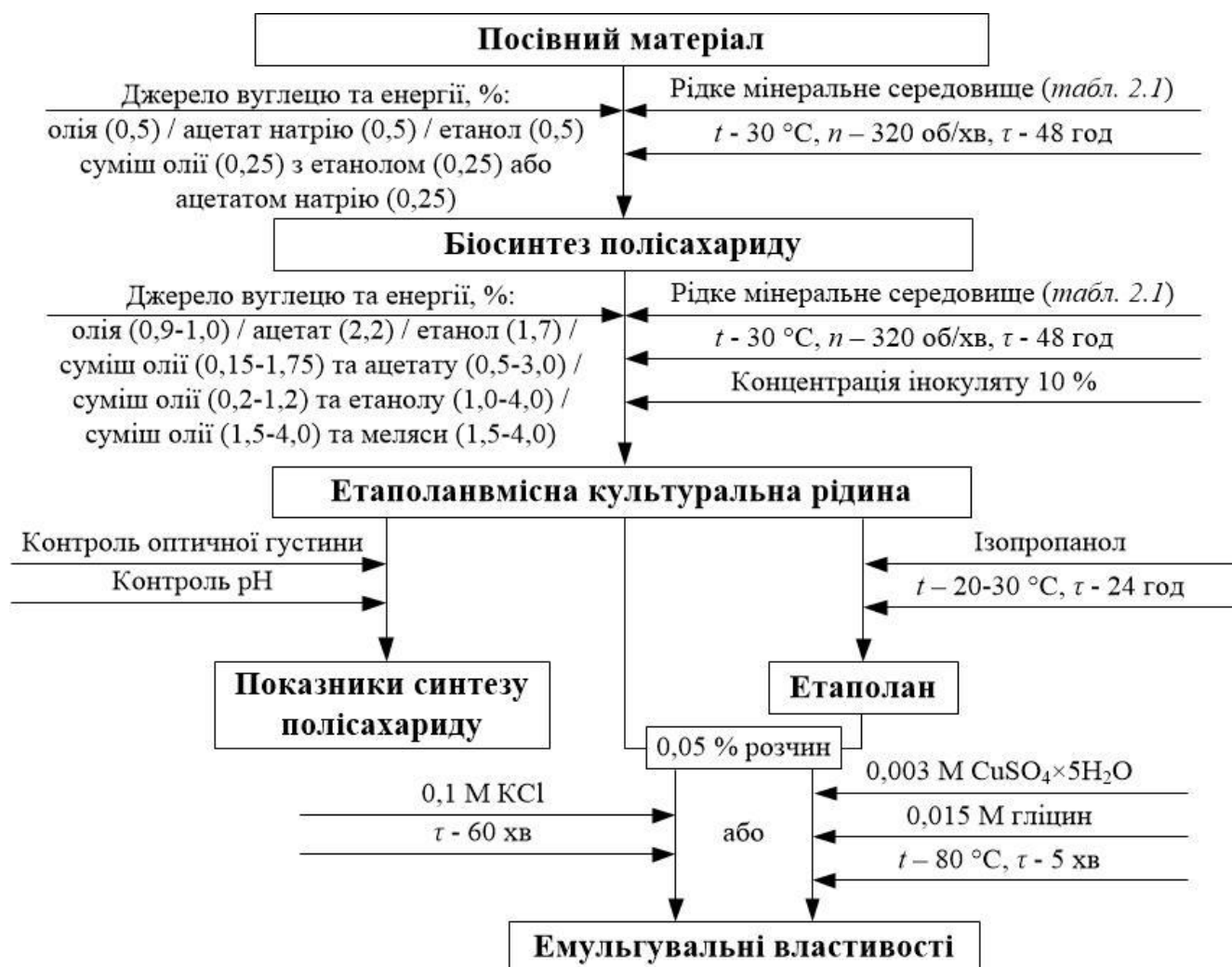
Рисунок 2.2 – Принципова схема проведення експериментальних досліджень з біосинтезу етаполану штамом Acinetobacter sp. IMB B-7005
