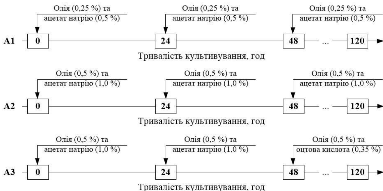
Рисунок 2.3 – Схема дробного внесення субстратів при рості бактерій на суміші соняшникової олії та ацетату натрію
