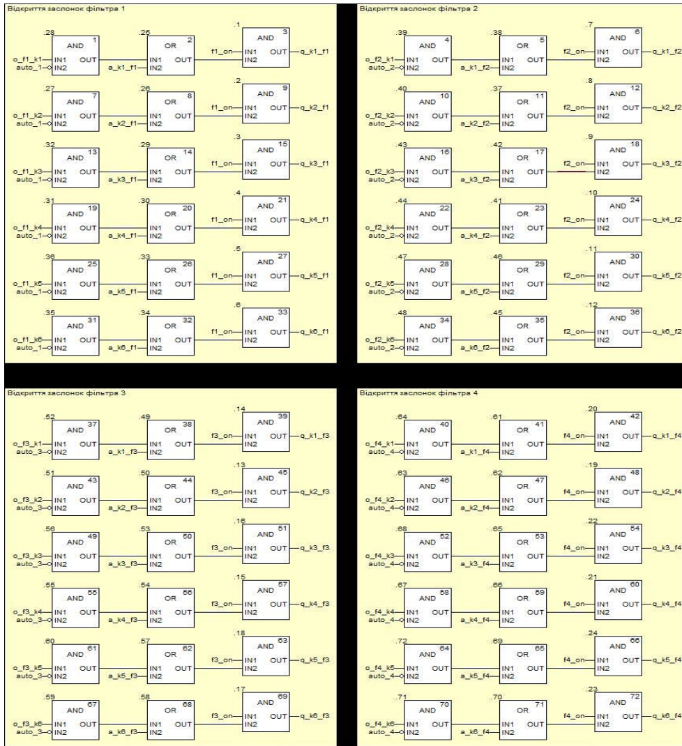
Рисунок 5.8. Відкриття заслонок різних фільтрів кінцевих вимикачів.
