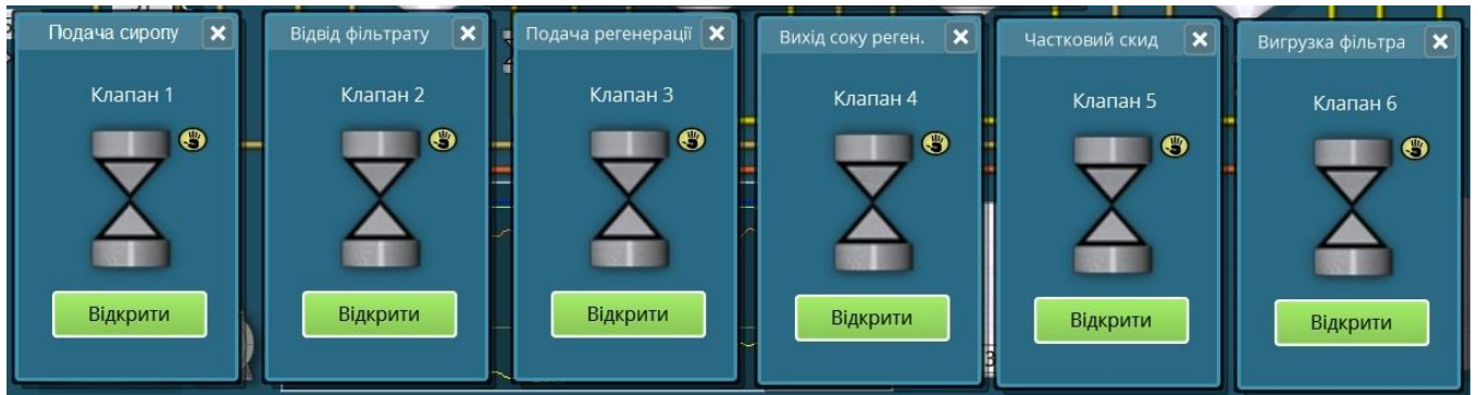
Рисунок 6.5. Вікно управління клапанами фільтра в ручному режимі.
