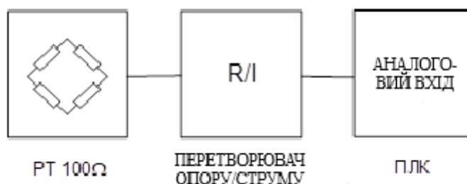
Рисунок 1.2 – Структурна схема вимірювача температури
