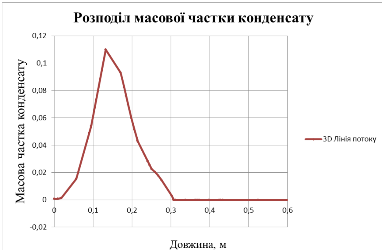
Рисунок 2.14 — Графік розподілу масової частки конденсату по 3D лінії потоку пари
