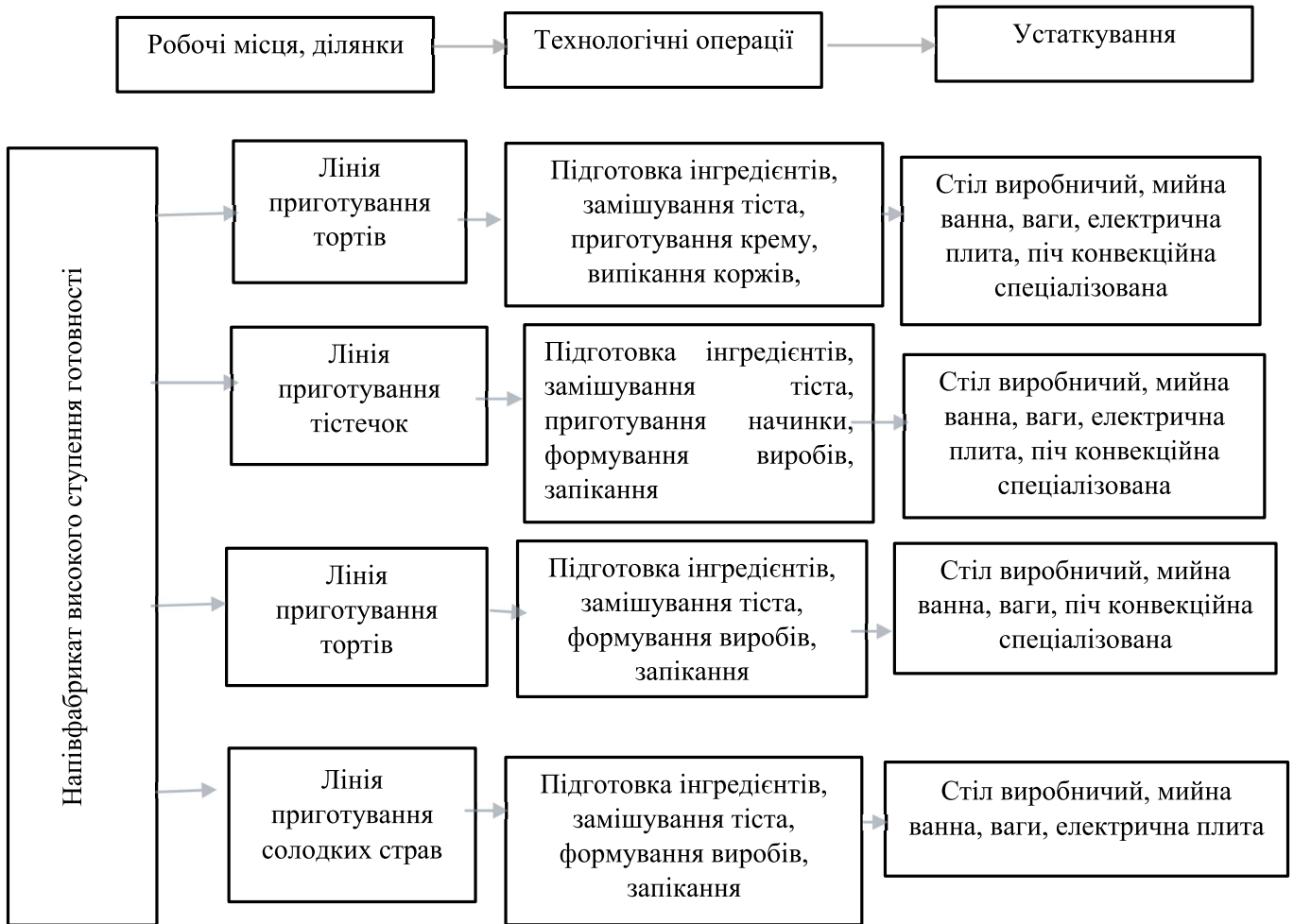
Рис. 2.1 Структурно-технологічна схема організації роботи кондитерського цеху
