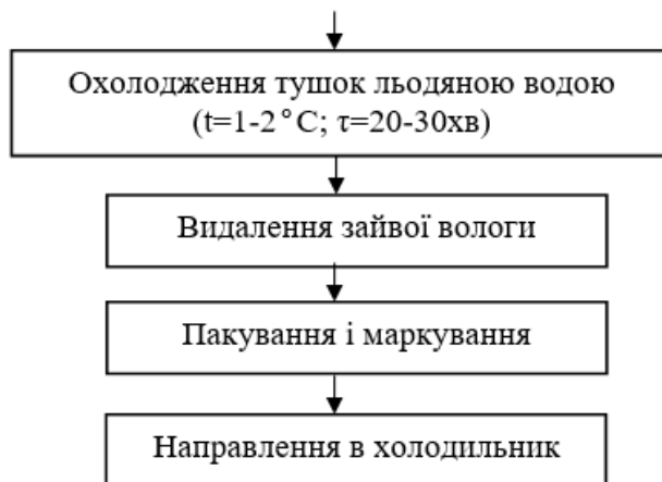
Рис. 2.1 – Принципово-технологічна схема переробки птиці з переробкою перо-пухової сировини на птахопереробному комплексі ТОВ «Вінницька птахофабрика»
