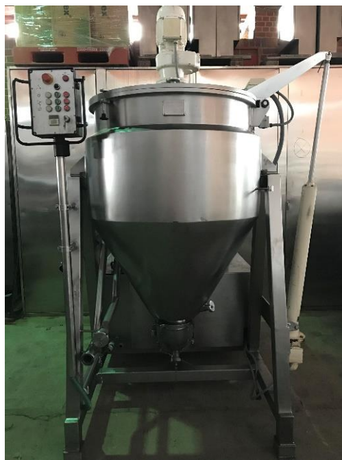
Рис. 4.1. Лінійний гомогенізатор Figma Koruma: 1 – подача продукту; 2 – вихід продукту; 3 – гомогенізатор; 4 – вихід залишків; 5 – система
