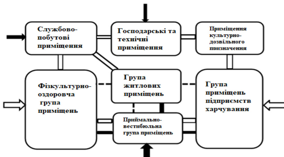
Рисунок 3.1– Функціональна схема засобу розміщення
