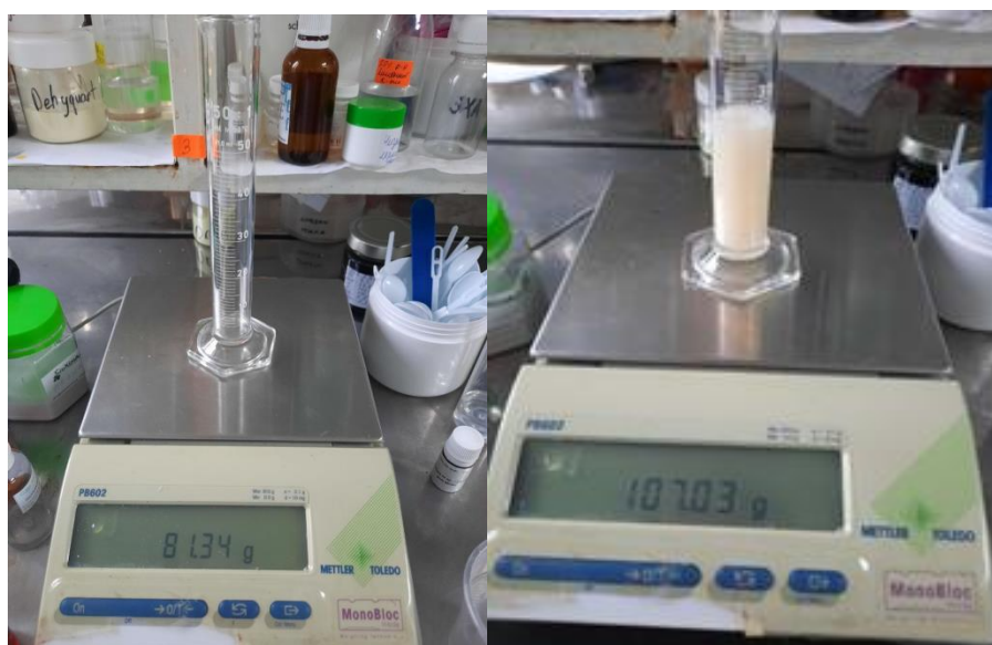
Рисунок 3.3 – Вимірювання густини зразок 5
