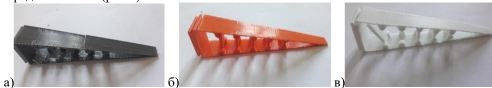
Рис. 1. Вид та місце руйнування пальця після випробування на втому, виготовленого з матеріалу: а) ABS; б) PLA; в) Elastan
