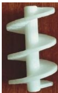
Рисунок 2. Схема вставки макаронной матрицы с предварительным уплотнением, разогревом и пластификацией теста:
