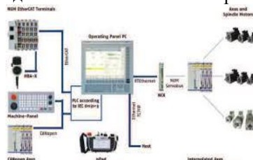
Рис. 1. Загальна схема Flexium ЧПК
