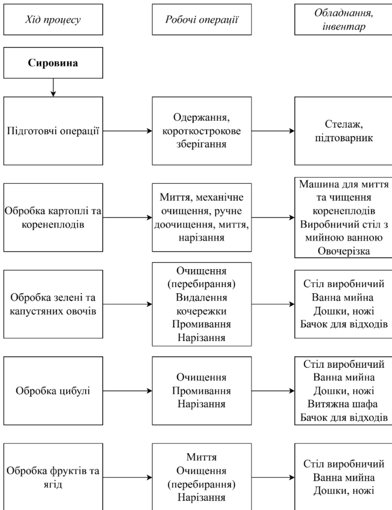
Рис.3.4 - Структурно-технологічна схема виробничого процесу овочевого цеху
