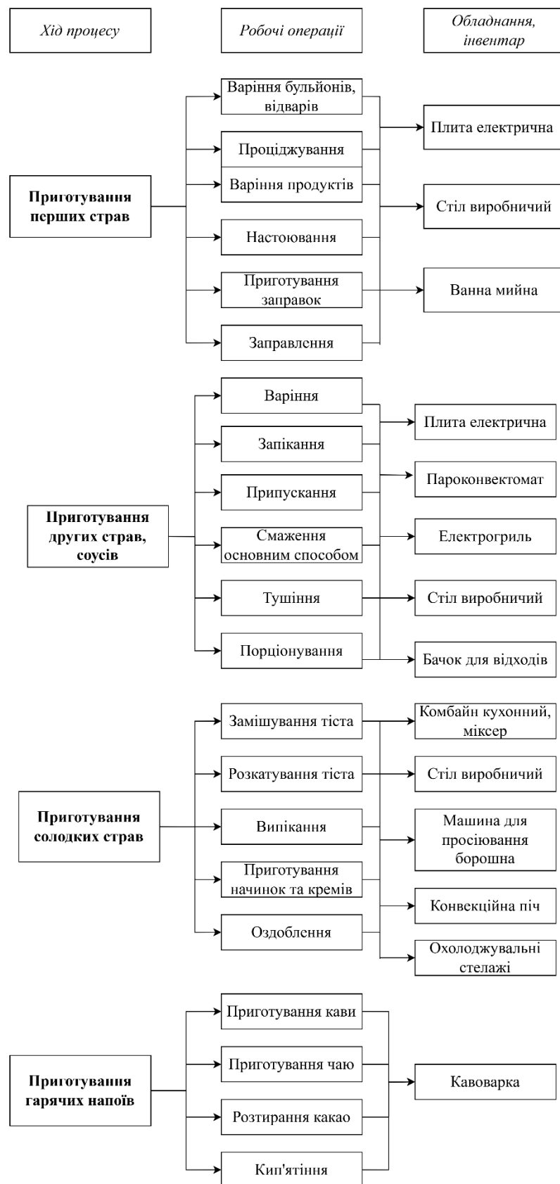
Рис.3.5 - Структурна схема виробничого процесу у гарячому цеху
