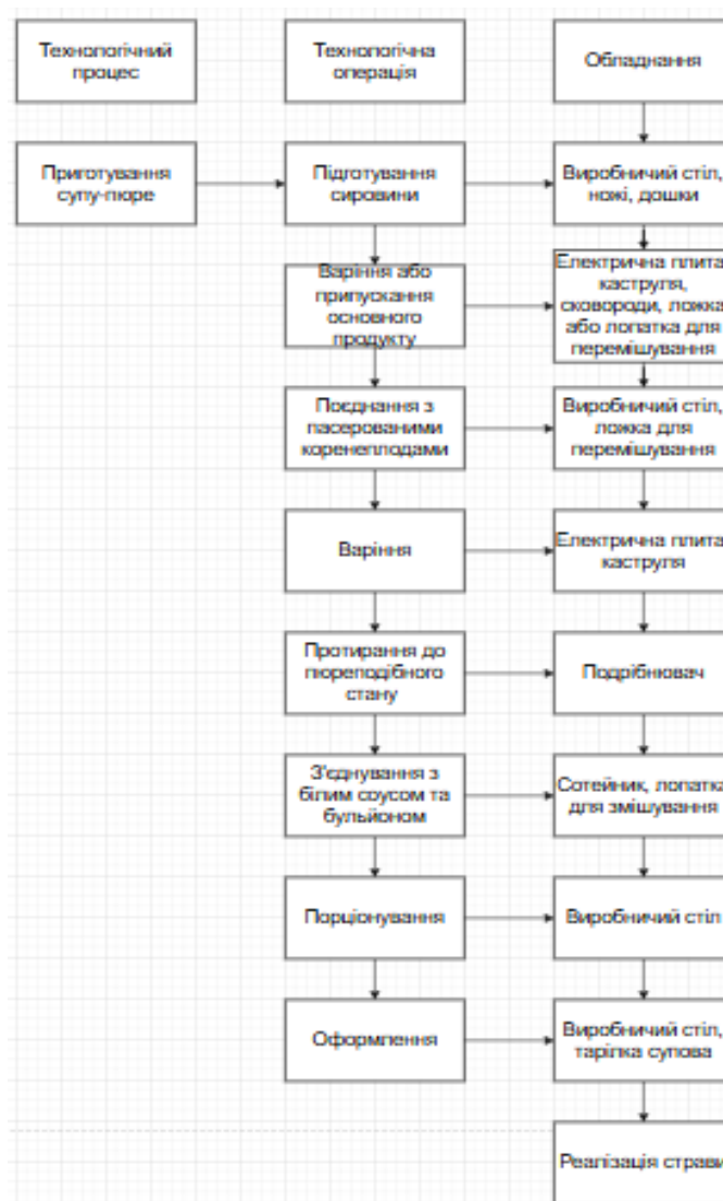
Рис. 1.1- Принципова технологічна схема приготування крем-супу
