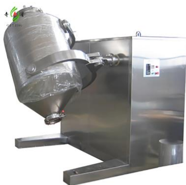
Рис.9.1. Зображення барабанного змішувача моделі SYN-50 та SYN-200 [180]
