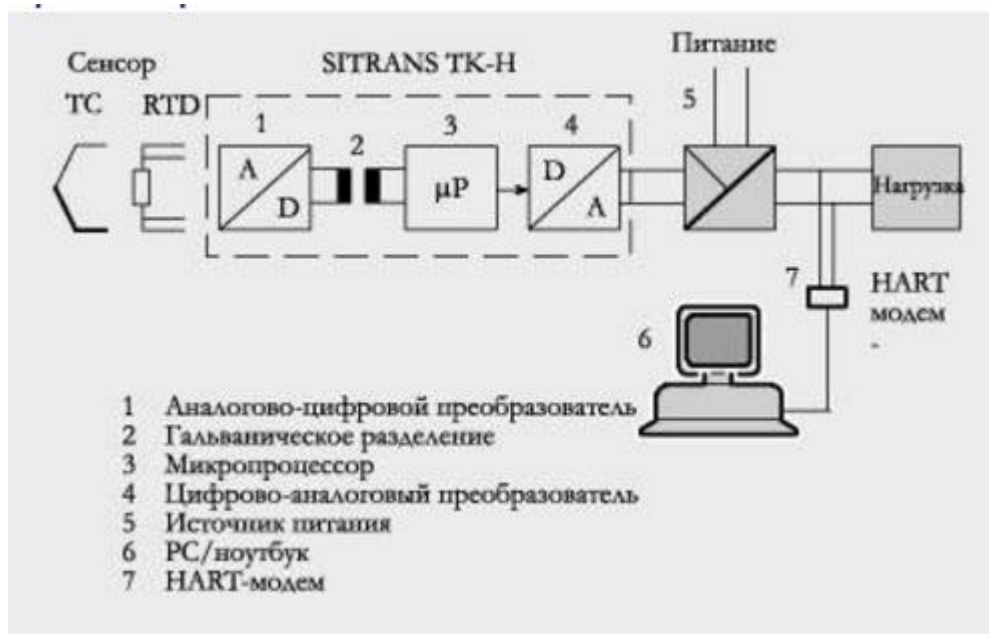
Рис. 2.1 Принципова схема перетворювача температури SITRANS ТК-Н
