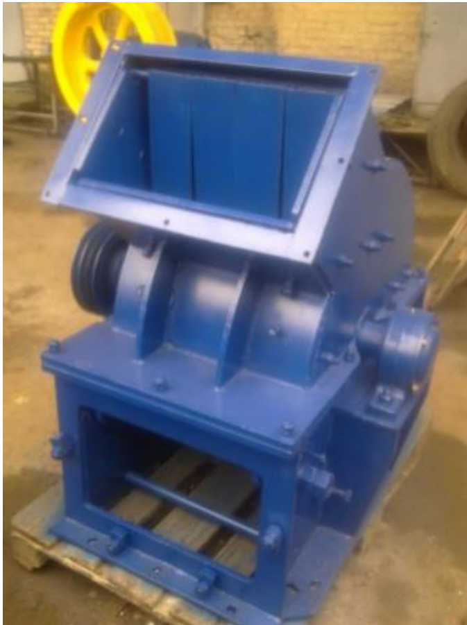
Рисунок 2.2 Молоткова дробарка СМД-112
