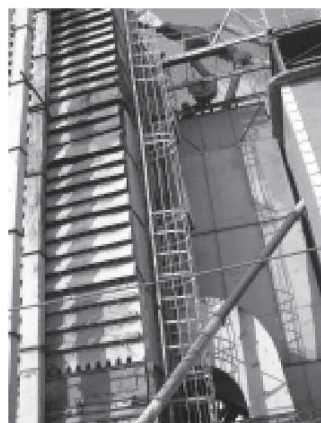
Рис. 3. Модернізована зерно сушарка ДСП-32от із спадними режимами сушіння і реверсним сушінням
