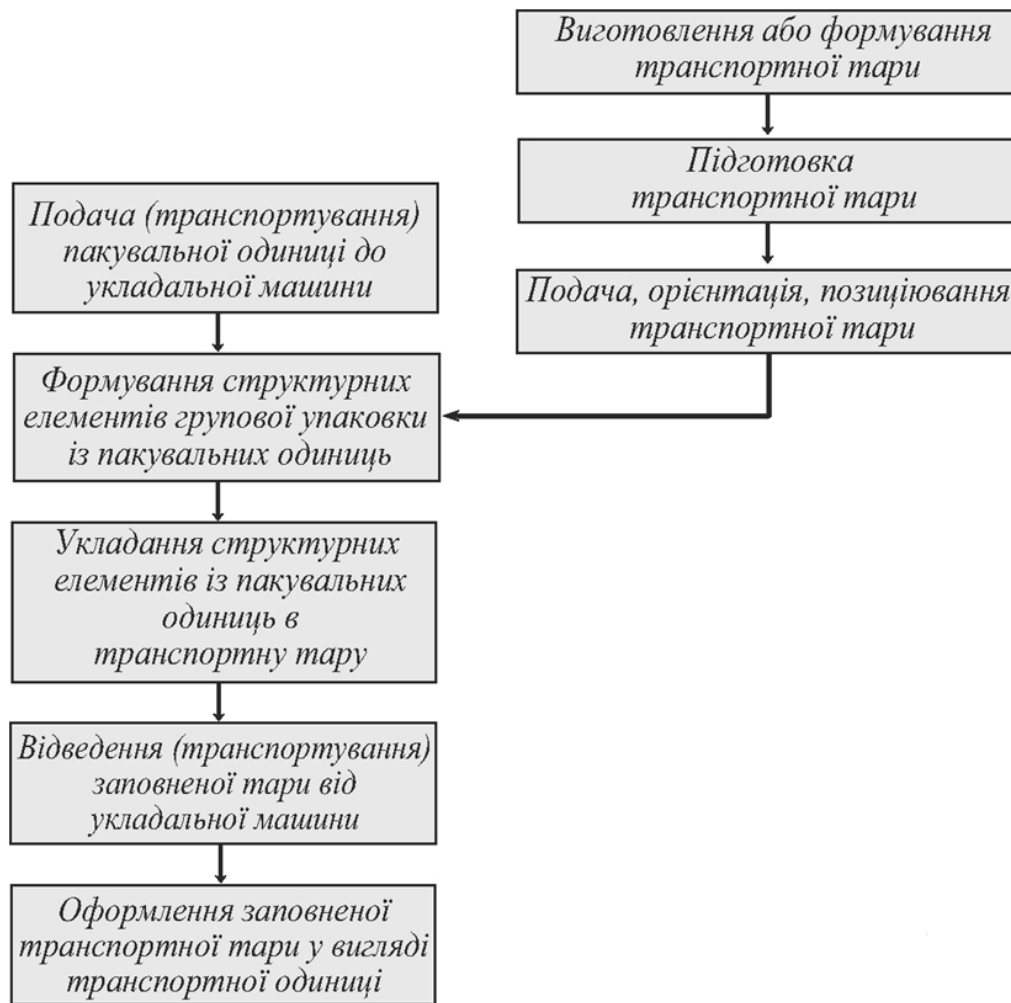
Рис.1.1. Технологічна схема укладання пакувальних одиниць в транспортну тару
