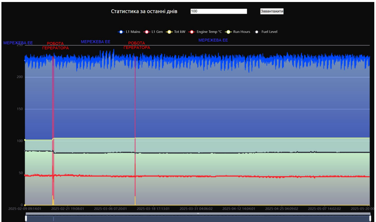
Рисунок 5.3. Панель відображення архівних показників із дизель генераторної установки (червона лінія – робота генератора, синя – наявність ЕЕ в мережі)
