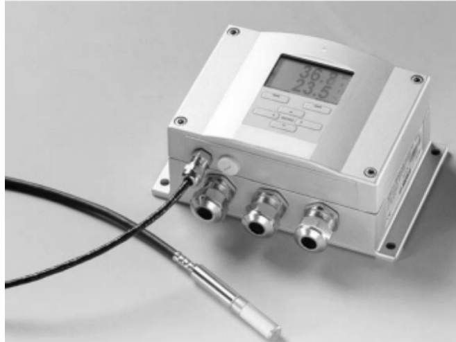
Рис.4.2. Вимірювальний комплект 90.7023/333 для важкодоступних місць
