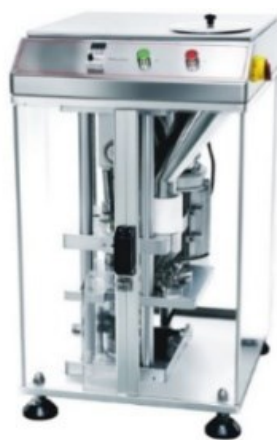
Рис.9.3. Таблетпрес однопуансонний DP 12 [185]
