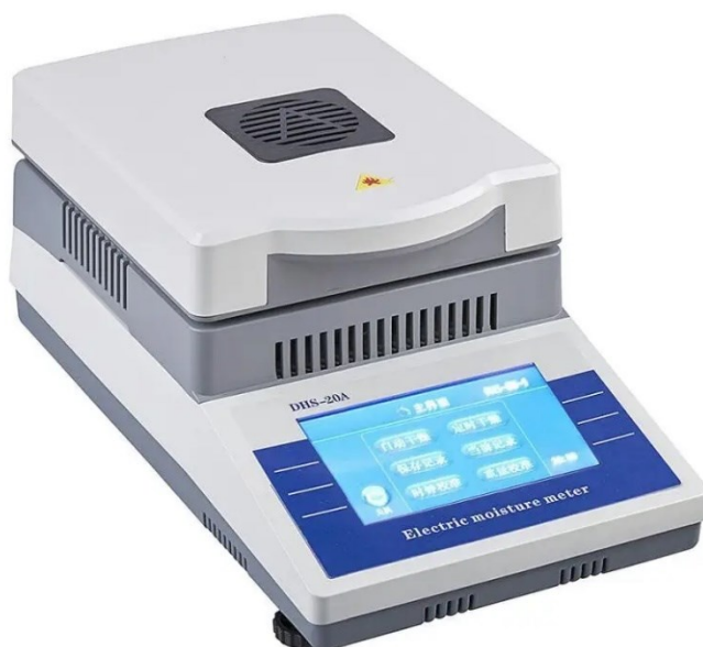
Рис.8.4. Ваговий аналізатор вологості JS50-5T [159]
