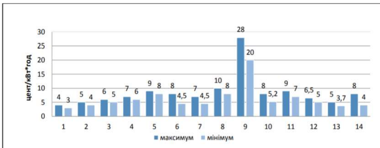
Рис. 16. – Середні значення мінімальної та максимальної електричної енергії на електростанціях на основі ВДЕ і різних видів палива: 1 – мікро- та малі ГЕС; 2 – ВЕС; 3 – геотермальні станції; 4 – ТЕС на відходах деревини; 5 – газифікація біомаси; 6 – газ звалищ; 7 – тверді побутові відходи; 8 – сонячні термодинамічні станції; 9 – фотоелектричні станції; 10 – ТЕС на вугіллі; 11 – екологічно чисті ТЕС; 12 – ТЕС на газі; 13 – газотурбінні з комбінованим циклом; 14 – атомні станції.
