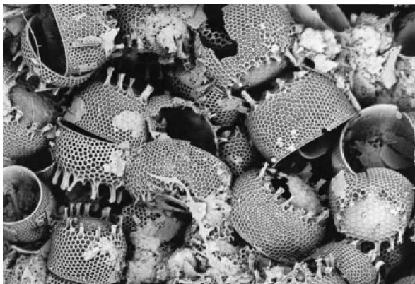
Рис.1 Діатомітова земля (кізельгур) під мікроскопом
