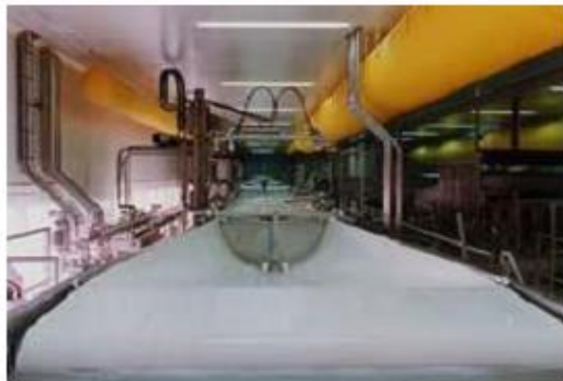
Рис. 1.12. Апарат безперервної дії фірми Алрта для виготовлення сирного зерна: 1 – впускна труба; 2 – зона сквашування; 3 – жолобоподібний стрічковий транспортер; 4 – робоча ємність; 5 – електростатичний відділювач згустку; 6 – пристрій для розрізання пласту (горизонтальний); 7 – пристрій для поперечного розрізання пласту; 8 – пристрій для очищення розділювальних перегородок
