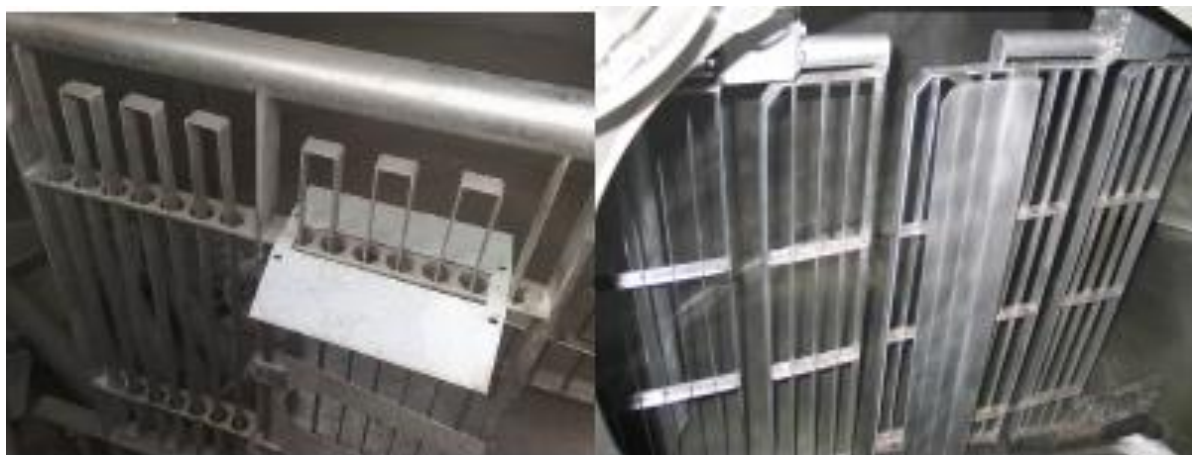
Рис. 1.4. Різально-перемішувальний робочий орган сироробної ванни
