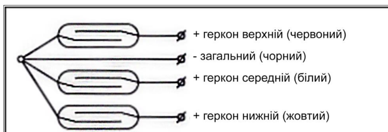
Рисунок 2.10 – Зовнішній вигляд трирівневого поплавкового датчика рівня ПДУ-3.3
