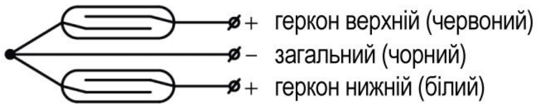
Рис. 18 – Схема підключення датчика рівня Balluff BTL0TW
