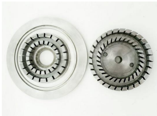
Рис. 4.4 Обертовий ротор і нерухомий статор насоса диспергатора
