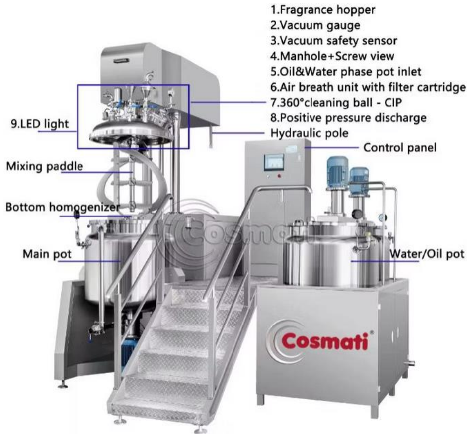
Рис. 1.8. Вакуумний лопатевий гомогенізатор: Перекласти позиції
